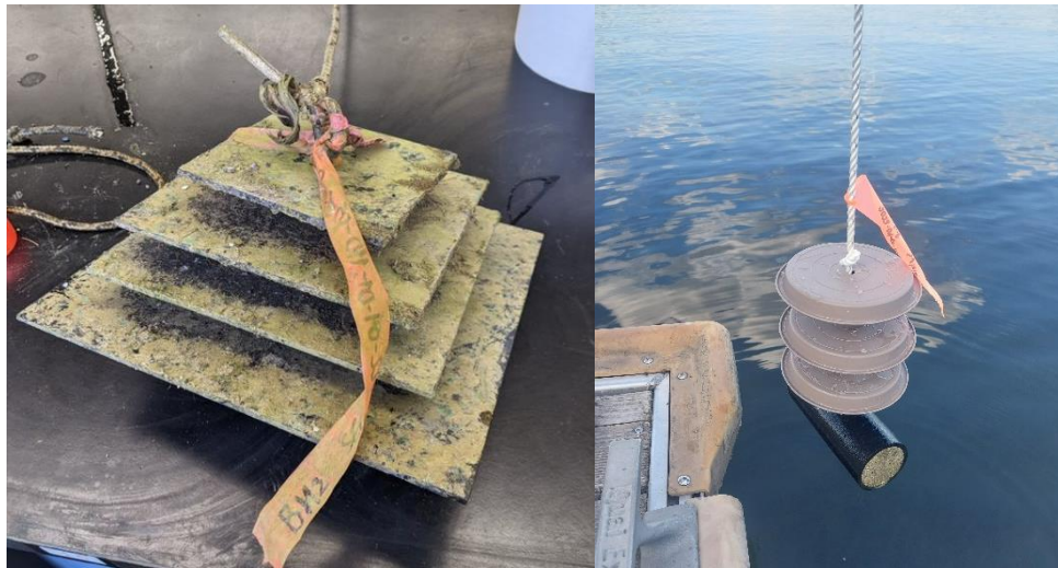
Figure 4 : Photo d'un substrat pyramidal (gauche) et d'un petit substrat collecteur pour citoyens (droite)
